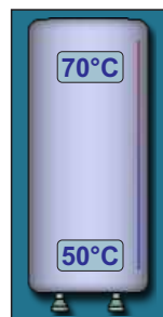
Réservoir d'accumulation avec l'affichage de la température en haut et celle en bas
